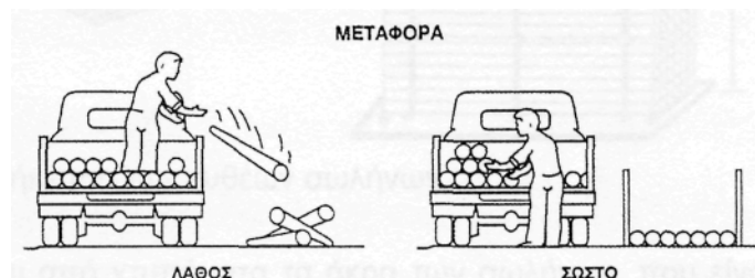
Σχήμα 3.9: Ανορθόδοξος και σωστός τρόπος φορτοεκφόρτωσης σωλήνων.
